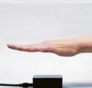
Sensor sendet Infrarotstrahlung an die Hand, venöses Blut absorbiert Strahlung
