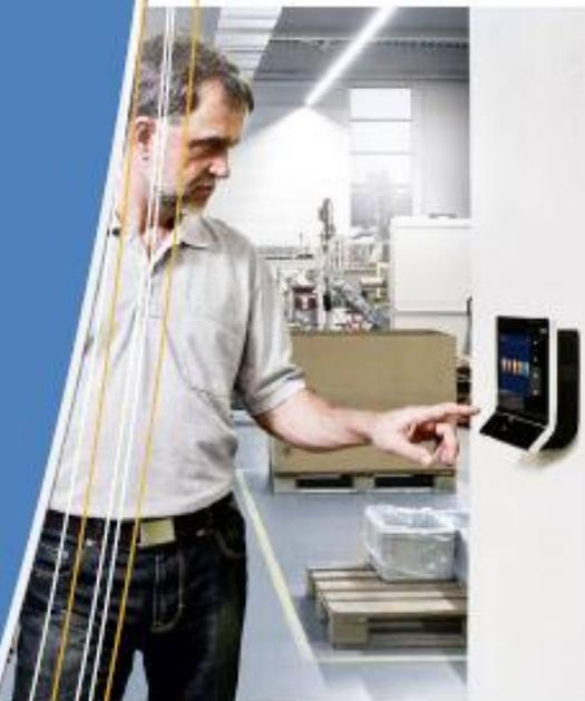
Datenerfassung am stationären RFID-Terminal
